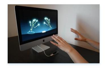
Leapmotion主要目标是跟踪手指运动,具有毫米级的精度,可以捕捉到绝大部分的手部动作。通过内置的两个不同角度的摄像头,捕捉两个方位的手部图像并重建出真实世界三维空间手部的运动信息。
