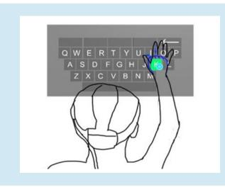
工作方式:通过HMD的前置摄像头捕获手掌和手势的位置。也就是说,使用者使用手掌在空中的位置来指示光标的位置,以作为基于手的"指向"。使用者根据他们的手在虚拟键盘上移动光标。
