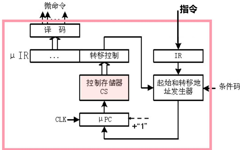
最初把固化在ROM的微程序称**固件 (Firmware)**，表示用软件实现的硬部件，现在对固件通俗的理解是在ROM中“固化的软件”。
