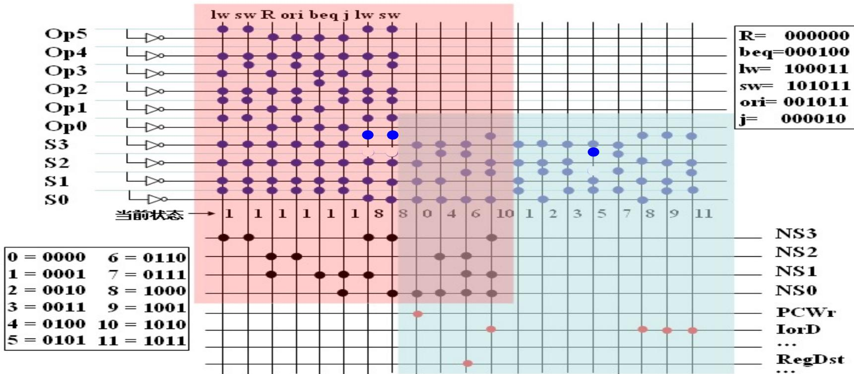
左上角：由操作码和当前状态确定下一状态的电路
